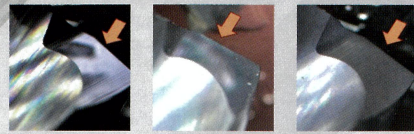
特殊表面処理したギャッシュ部 (コーティング前) 特殊表面処理したギャッシュ部 (コーティング後) 特殊表面処理していないギャッシュ部 (コーティング後)
