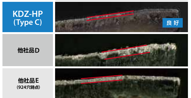
逃げ面摩耗状態 (1,232穴時点)
