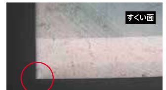
ランドがなく刃先先端からすくい面を形成 食付きが向上し、高精度・安定加工が可能 (~φ12)
