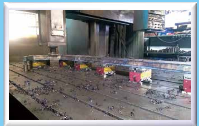
永磁クランピングブロックで大型ワークを固定し段取り時間を短縮
