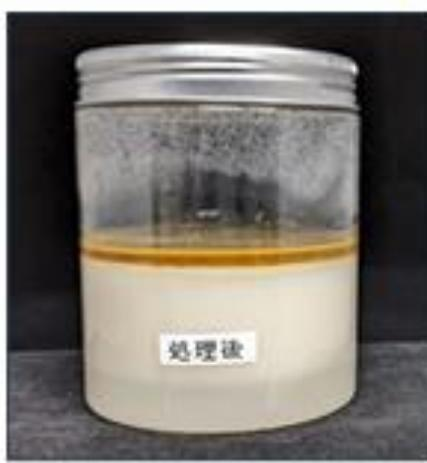
切削液と油分が結合した浮上油と、分離した状態での浮上油の比較です。
