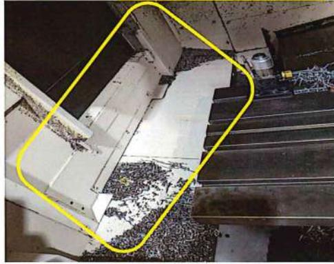
CF-50 を搭載している機械は切りくずが流れやすいです。
