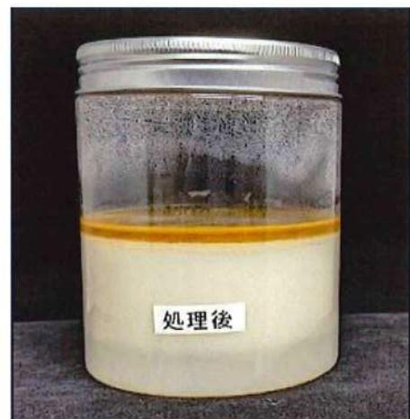
切削液と油分が結合した浮上油と、分離した状態での浮上油の比較です。
