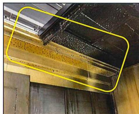
【実例③】3日程でクーラント内部の汚れが剥離してきた。加工室もきれいになってきた。切削液の色が白くなってきた、臭気も改善された。
